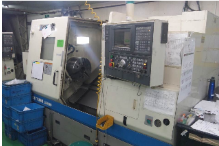
NC旋盤 OKUMA SPACE TURN LB400 タンク容量:約 300L
